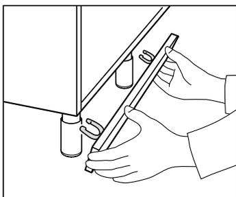
Se devi installare uno zoccolo, ora è il momento di farlo. Segui le istruzioni di montaggio.
