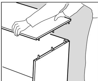
Monta tutte le strutture per pensili secondo le istruzioni di montaggio. I cassetti, le ante e gli accessori interni vanno inseriti in un secondo momento.
