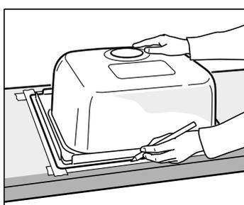
Posiziona il piano di lavoro e segna il punto in cui devi installare il lavello. Traccia il profilo interno del mobile base sul lato inferiore del piano di lavoro. Questo ti aiuterà ad allineare il lavello. Capovolgi il piano di lavoro e traccia il contorno del lavello sopra il nastro adesivo.
