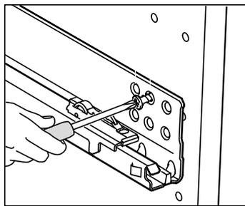
Una volta fissate le guide dei cassetti esterni, fissa quelle per i cassetti interni. Le guide dei cassetti interni vanno montate sulla fila di fori più interna nel mobile.
