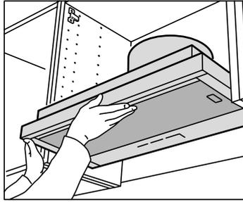
Installa la cappa aspirante. Le cappe IKEA possono essere installate in due modi: collegate all'esterno, ovvero utilizzate in modalità aspirante, oppure usate in modalità ricircolo con un filtro al carbone attivo. Entrambe le opzioni di installazione sono descritte nelle istruzioni di montaggio fornite con il prodotto.
