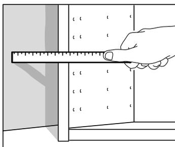
Controlla che la parete sia dritta, usando la livella. Se lo è, misura la distanza tra la parete e il mobile e segnala sulla parte superiore e inferiore del riempitivo.
