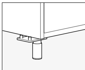
Durante l'installazione, puoi usare come sostegno le gambe che collegano due mobili. Ricorda di usare l'anello distanziatore in dotazione con le gambe.
