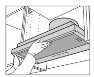
Installa la cappa aspirante. Le cappe aspiranti IKEA possono essere installate in due modi: collegate all'esterno con il tubo di ventilazione, ovvero utilizzate in modalità aspirante, oppure usate in modalità ricircolo con un filtro al carbone attivo. Entrambe le opzioni sono descritte nelle istruzioni di montaggio fornite con il prodotto.
