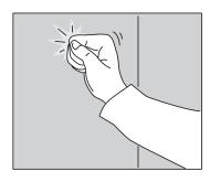
Controlla che le pareti siano abbastanza resistenti da reggere i binari di sospensione e i mobili. A seconda del materiale della parete, si consiglia di installare il binario su un montante o una trave portante. Può esserti utile un rilevatore elettronico di metalli e cavi elettrici.
