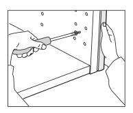
Se hai previsto un mobile alto, monta prima il rivestimento laterale.
