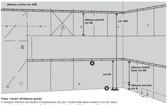
Il margine inferiore del binario di sospensione (A) per i mobili base deve trovarsi a cm 82 sopra il punto più alto del pavimento (B). Se la tua cucina è alta cm 208, lascia cm 120 tra il margine inferiore del binario per i mobili base e il margine inferiore del binario per i pensili/mobili alti. (Se la tua cucina è alta cm 228 o cm 248, devi lasciare cm 140 risp. cm 160.)
