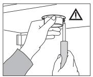
Installa l'illuminazione e gli elettrodomestici. Se pratichi dei fori, poggia la punta del trapano su una tavoletta di legno, in modo che il bordo inferiore del foro non si scheggi.
