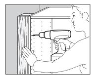
Per assicurarti che il riempitivo resti in posizione, applica prima una barra di supporto alla parete. Pratica i fori nel mobile per le viti necessarie a unirlo al riempitivo. Metti il riempitivo in posizione. Inserisci le viti nei fori praticati. Una volta posizionati tutti i riempitivi, sigillali con il silicone per assicurarne la tenuta ermetica.
