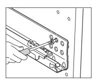
Una volta fissate le guide dei cassetti esterni, procedi fissando quelle per i cassetti interni. Le guide dei cassetti interni devono essere montate sulla fila di fori più interna.
