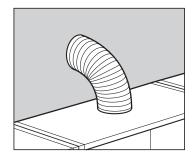
Pratica il foto nel pannello posteriore o superiore del pensile, seguendo le istruzioni di montaggio. Per ragioni di sicurezza e funzionalità, attieniti esattamente alle misure riportate nelle istruzioni di montaggio della cappa.
