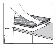
Procedi allo stesso modo per l'inserimento del piano cottura, così come hai fatto per il lavello. Segui le istruzioni di montaggio del piano cottura.
