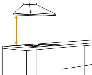
**05** Per motivi di sicurezza e di funzionamento, la cappa deve essere installata all'altezza raccomandata, come indicato nelle istruzioni di montaggio. L'altezza varia in base alla scelta di installare un piano cottura a induzione o a gas.
