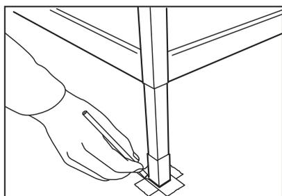
Una volta collocate le strutture, applica temporaneamente del nastro adesivo sotto ogni gamba e segna il contorno esatto del cappuccio di protezione, poiché questo determina la posizione finale della tua isola per cucina.
