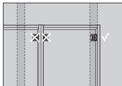
Le travi della parete, che sono in genere distanziate tra loro di cm 30, cm 45 o anche cm 60, sono in grado di sostenere il peso dei tuoi pensili. Poiché i mobili hanno però larghezze diverse, è probabile che i punti di fissaggio degli elementi non si trovino in corrispondenza delle posizioni delle travi.
