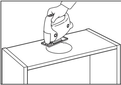
Se vuoi posizionare la cappa sotto un pensile, devi praticare un'apertura con la sega prima di fissare l'elemento alla parete. Segui le istruzioni di montaggio della cappa per effettuare le predisposizioni necessarie. Una volta praticata l'apertura necessaria, sigilla gli interstizi con il silicone.
