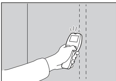
Assicurati che le pareti siano resistenti abbastanza da sostenere il peso dei tuoi mobili. A seconda del materiale della parete, si consiglia di fissare l'elemento su un montante o una trave portante. Utilizza un rilevatore di montanti per localizzare le travi nella parete.
