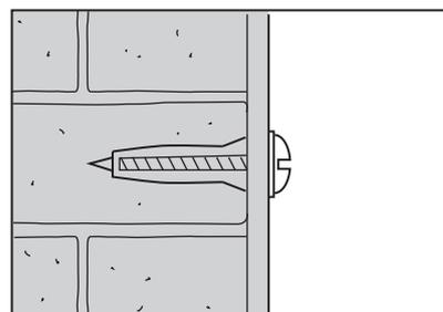
Scopri con che tipo di parete hai a che fare. Le strutture solide come la muratura, difficili da penetrare all'interno ma in grado di sostenere un peso elevato, richiedono tasselli e viti speciali.
