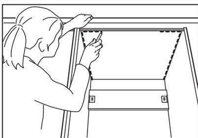
**Per ritagliare l'alloggiamento per il lavello**, inizia tracciando il profilo interno del mobile base sul lato inferiore del piano di lavoro.
