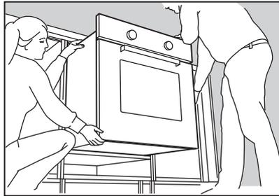
Il mobile base per il forno è progettato per poter posizionare il forno da incasso sopra un ripiano rinforzato. Considera che dovete essere in due per reggere il forno e inserirlo correttamente nella sua sede. Non appena posizionato il forno, devi fissarlo con le viti comprese nella confezione.
