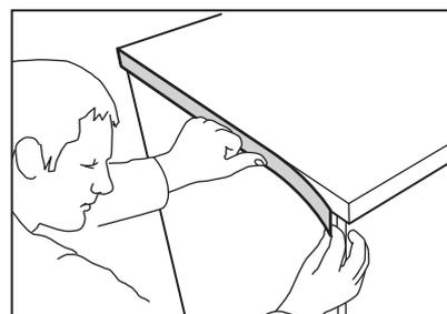
Dopo aver tagliato il piano di lavoro, sigilla il bordo di taglio grezzo per evitare che l'acqua o l'umidità penetrino all'interno, causando rigonfiamenti o rotture del materiale. Segui le istruzioni di montaggio del piano di lavoro per applicare il bordo per top e ripiano compreso nella confezione di tutti i piani di lavoro pretagliati IKEA. In mancanza del bordo per ripiano, ti consigliamo di sigillare il bordo con il silicone.
