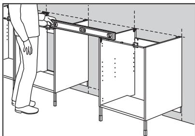
Se installi un mobile base accanto all'alloggiamento per la lavastoviglie, è necessario appoggiare la livella sia sul lato anteriore che posteriore dei mobili. Assicurati che la distanza tra i due elementi sia di cm 60, sul bordo anteriore e su quello posteriore a ridosso della parete. Se sono allineati correttamente, puoi fissare il mobile alla parete.
