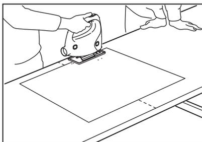
**Per ritagliare l'alloggiamento per il piano cottura**, localizza prima il punto centrale del mobile base. Nella guida all'installazione per il piano cottura sono riportate le misure dell'alloggiamento e le distanze minime da rispettare. Assicurati che il perimetro di taglio non coincida con il binario superiore del mobile.
