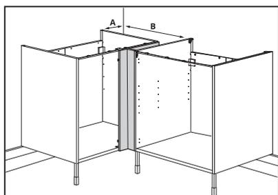
Se vuoi installare un mobile base angolare con un'anta di cm 40 di larghezza, posizionalo a mm 268 di distanza dalla parete (A). Se vuoi installare un mobile base angolare con un'anta di cm 60 di larghezza, posizionalo a mm 468 di distanza dalla parete (A). In entrambi i casi, posiziona il mobile adiacente a mm 688 dalla parete (B).
