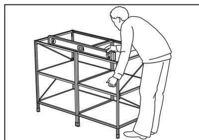
Dopo aver inserito le gambe nei supporti di ancoraggio, collega tutte le strutture con gli accessori di collegamento compresi nella confezione. Ti consigliamo di usare una livella grande, per controllare che le strutture siano perfettamente in piano da tutti i lati. Puoi regolare l'altezza delle gambe per effettuare piccole registrazioni.
