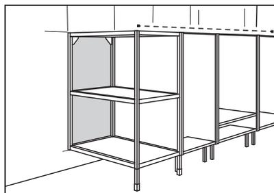
Se installi una struttura base a giorno, non usare i listelli in legno sulla parete. Prima di fissarla alla parete, allinea il bordo superiore della struttura a giorno a quello del mobile base adiacente.
