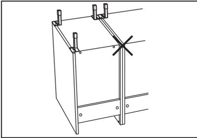
Per installare uno zoccolo, posiziona la gamba in modo che la piastra della gamba sia in linea con il bordo del mobile. Poiché lo zoccolo viene fissato alle gambe, hai bisogno di una gamba supplementare nell'angolo posteriore sui fianchi laterali del mobile.
