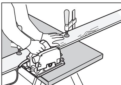
Per tagliarlo perfettamente dritto, fissa un regolo sul piano di lavoro con i morsetti a vite. Se usi una sega circolare o un seghetto alternativo, taglia il piano di lavoro con il lato inferiore rivolto verso l'alto per evitare che si scheggi. Ma se utilizzi una sega a mano, posizionalo con il lato superiore rivolto verso l'alto. Consiglio: fai reggere l'estremità del piano di lavoro da una seconda persona mentre lo tagli, in modo da non scheggiare i bordi.
