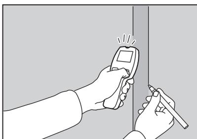
Perciò, per prima cosa è necessario localizzare con il rilevatore le travi nella parete. Le travi sono in genere montanti verticali in legno, ma possono essere anche profilati sottili in metallo. Entrambe le tipologie si estendono dal pavimento al soffitto.
