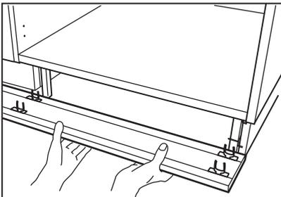
Posiziona lo zoccolo sulla parte anteriore e segna il punto in cui vuoi tagliarlo. Dopo averlo tagliato a misura, applica sullo zoccolo il bordo e i ganci in plastica per fissarlo alla gamba. Ripeti la procedura per ogni sezione dello zoccolo.
