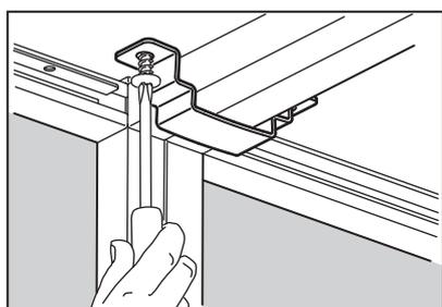
Prendi nuovamente le misure del piano di lavoro e adatta le dimensioni, se necessario. Quando lo appoggi sull'isola, assicurati che la profondità della sporgenza sia identica su tutti i lati. Fissa il piano di lavoro con i supporti compresi nella confezione della struttura base.
