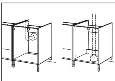
Se è il momento di pensare al lavello e al miscelatore, installa il mobile base per lavello ENHET, progettato in modo che i tubi possano entrarvi dal pavimento o dalla parete. Consulta le istruzioni di montaggio per conoscere le diverse configurazioni possibili.
