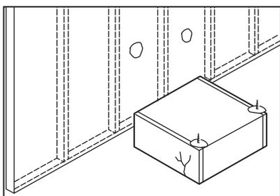
Se le tue pareti sono in cartongesso (pannelli in gesso montati sulla trave), non basta fissare gli elementi solo ai pannelli (nemmeno con i tasselli ad ancora).
