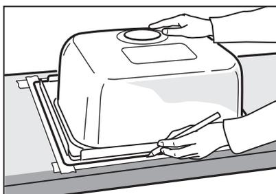
Sul piano di lavoro con il lato inferiore rivolto verso l'alto, posiziona il lavello capovolto all'interno del contorno tracciato, assicurandoti di centrarlo equidistante dalla marcatura. Traccia il contorno del lavello.
