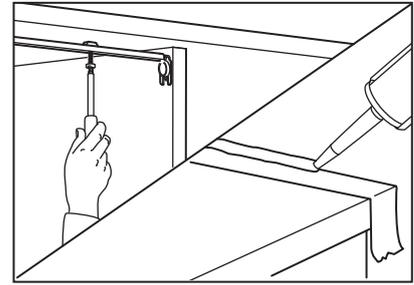
Una volta che i lati del piano di lavoro sono alla stessa altezza e allineati alla parete, fissa il piano di lavoro ai mobili e applica il silicone per evitare che i liquidi possano penetrarvi all'interno.
