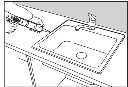
Wenn die Teile der Arbeitsplatte auf gleicher Höhe und an die Wand angepasst sind, befestigst du die Arbeitsplatte an den Schränken und trägst Silikon auf, um zu verhindern, dass Flüssigkeiten in die Arbeitsplatte eindringen können.
