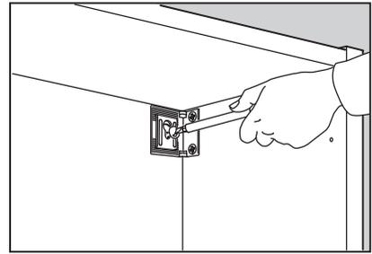
Fissa il pensile con una vite della lunghezza e dello spessore corretti (durante l'intero processo d'installazione, dovrai allentare un po' le viti di tanto in tanto per allineare correttamente i pensili e le strutture).
