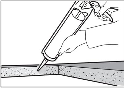
Pulisci i bordi grezzi dell'alloggiamento e levigali un po' con la carta vetrata. Applica il silicone per evitare che l'umidità penetri nel piano di lavoro. Lascialo asciugare bene prima di installare il lavello e/o il piano cottura.
