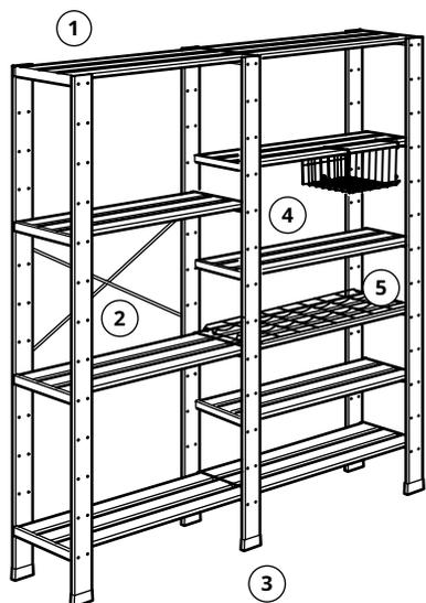
1. Avec 6 tablettes maximum par section, la charge maximale de chaque tablette de 47 cm de profondeur est de 50 kg et celle de chaque tablette de 28 cm de profondeur est de 35 kg.
