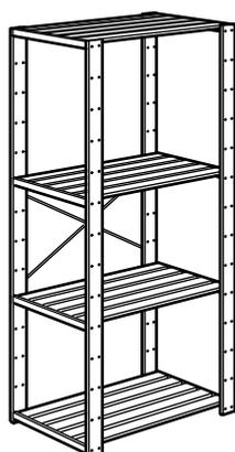
Section unique à tablettes profondes. La charge maximale de l'étagère est de 200 kg, 50 kg par tablette.
