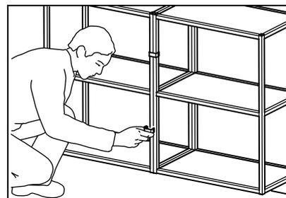
Lorsque tu places les éléments ou les caissons côte à côte, joins-les à l'aide des clips fournis.
