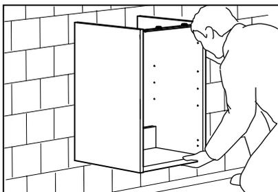
Veille à installer le matériel de fixation au dos du meuble lavabo, comme indiqué dans les instructions de montage. Ensuite, place délicatement l'élément sur les vis de fixation.
