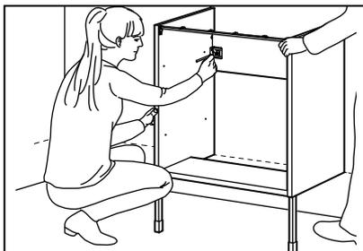
Localise les points de perçage. Place le bord inférieur de l'élément/caisson sur la ligne de base (235 mm), maintiens le meuble contre le mur et marque les trous de perçage pour la fixation murale. Mets de côté l'élément/le caisson et perce les trous aux endroits marqués.
