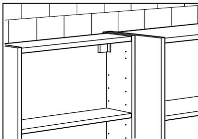
Si tu installes une colonne, aligne-la sur l'élément mural adjacent ou sur la ligne tracée précédemment pour la colonne. Une fois que tu as marqué les trous de perçage pour le matériel de fixation, répète l'ensemble des étapes: perce, scelle et fixe l'élément ou le caisson. Veille à ce que toutes les unités soient alignées avant de serrer les vis.
