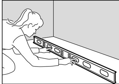
Vérifie les murs. Les murs doivent pouvoir supporter le poids de tes éléments muraux/caissons. C'est pourquoi il est essentiel que tu vérifies s'ils sont adaptés. Comme le matériel de fixation à utiliser varie en fonction du type de mur, il n'est pas fourni. Utilise celui qui correspond à ton mur. Demande conseil à un-e spécialiste pour trouver le matériel de fixation adapté à ton mur.
