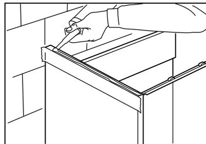
Applique du silicone sanitaire sur le bord supérieur du pourtour de l'élément bas. Pose du ruban de masquage pour protéger le pourtour de l'élément bas des coulures de silicone.
