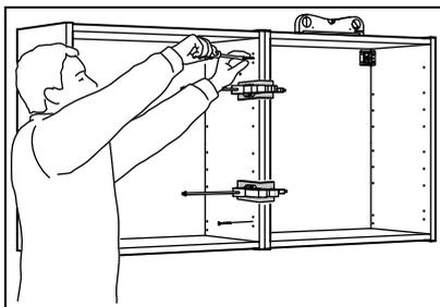
Si tu as deux éléments ou plus, aligne le second sur le premier. Une fois que tu as installé le deuxième élément, fixe les deux ensemble à l'aide des vis fournies.
