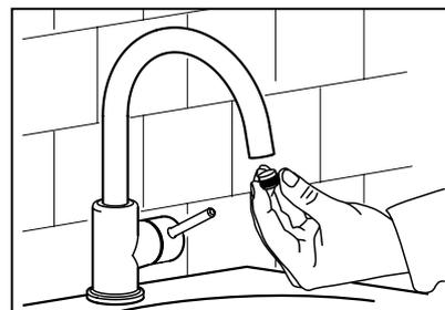
Tu peux à présent rouvrir l'arrivée d'eau. Enlève l'aérateur du robinet et fais couler l'eau pendant 5 minutes. Vérifie l'absence de fuites au niveau des raccordements et du siphon. Tu peux ensuite remettre l'aérateur sur le robinet.
