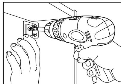
Répète maintenant le perçage et le scellement avant de serrer à moitié les vis (voir étape 2 sur la page précédente). Une fois que tu as fixé l'élément et que tu l'as aligné sur la ligne horizontale pour l'élément mural, serre les vis.
