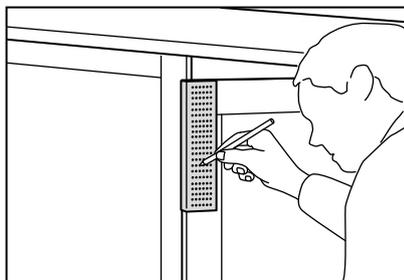
Une fois que tu as décidé où placer tes boutons et/ou poignées, nous te recommandons d'utiliser le gabarit de perçage FIXA. Ainsi, le montage des boutons et/ou poignées sera très simple, et le résultat parfait.
