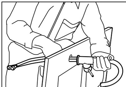
Maintenant, fixe le mitigeur à la vasque, comme décrit dans les instructions de montage du mitigeur. Serre d'abord les deux écrous qui fixent le mitigeur à la vasque sans les visser complètement, afin de pouvoir ajuster exactement la position du mitigeur une fois que la vasque sera installée sur l'élément bas.
