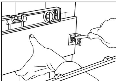
À l'aide du niveau à bulle, contrôle une nouvelle fois que ton meuble lavabo est parfaitement horizontal. Les pièces de fixation permettent de rattraper de légers écarts. Une fois que l'élément est horizontal, tu peux serrer les vis.
