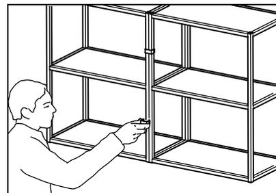
Lorsque tu installes les caissons côte à côte, joins-les à l'aide des clips fournis.
