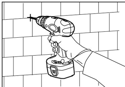
Perce les trous et remplis-les de silicone sanitaire. Perce les trous de fixation et insère les vis de fixation. Ne les visse pas encore à fond. Un foret diamant évite d'endommager le carrelage. Si tu n'en as pas, il vaut mieux appliquer une bande de masquage sur les carreaux. Tu évites ainsi de dégrader pendant le perçage.
