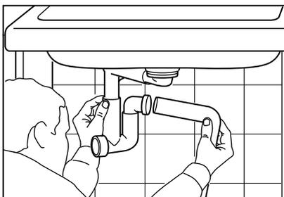
Une fois que le silicone est sec, termine l'installation du siphon et raccorde tous les tuyaux du mitigeur avec l'arrivée d'eau, comme décrit dans les instructions de montage.
