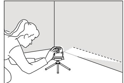
Ermittle die höchste Bodenerhebung und markiere die Stelle an der Wand. Von dieser Stelle aus misst du die Abmessungen zur Bestimmung der korrekten Arbeitshöhe für die Badezimmermöbel vornehmen.
