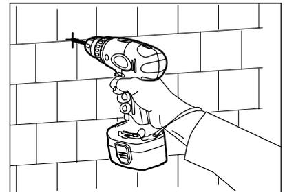
Bohre die Befestigungslöcher und verwende dazu eine Diamantbohrspitze. So verhinderst du, dass die Fliesen beschädigt werden. Wenn du keine solche Bohrspitze hast, klebst du am besten Abdeckband auf die Fliese. So verhinderst du ein Abrutschen beim Bohren.
