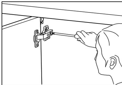
Befolge nun die Montageanleitung für die Installation der Türen und Schubladen. Wenn du die Türen eingehängt und die Schubladen eingeschoben hast, kannst du kleine Fehleinpassungen durch Einstellen der Scharniere und Schubladen beheben.
