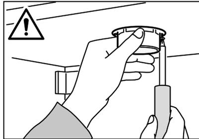
Wenn du dazu Löcher bohrst, unterlege dein Bohrstück mit einer Holzplatte. So trifft der Bohrer auf die Holzplatte, was verhindert, dass die Kante des Bohrlochs absplittert. Vergiss nicht, Sanitär-Silikon aufzutragen.
