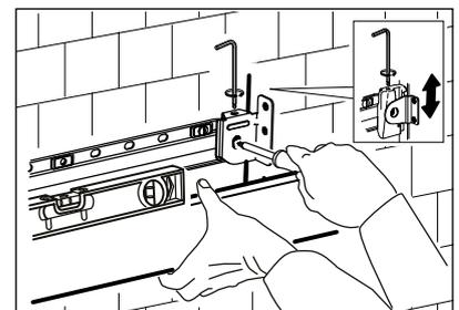
Nimm noch einmal die Wasserwaage, um sicherzustellen, dass dein Waschbeckenschrank waagrecht ausgerichtet ist. Du kannst kleine Abweichungen an den Fixiermöglichkeiten ausgleichen. Wenn der Schrank waagrecht ist, ziehst du die Schrauben fest.
