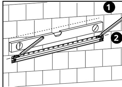
Positioniere die Schiene mit den oberen Befestigungslöchern an der zweiten Markierungslinie (2), die du für die Schiene gezogen hast. Markiere die Position der Bohrlöcher. Siehe dazu die Montageanleitung.
