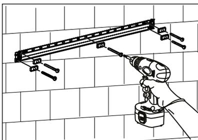
Bevor du die Schrauben festziehst, füllst du die Bohrlöcher mit Sanitär-Silikon.
