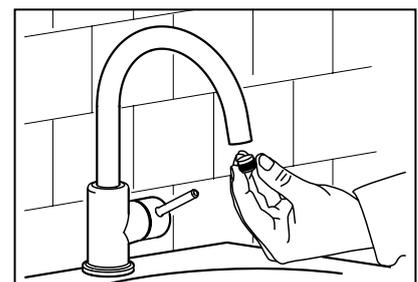
Jetzt kannst du das Hauptabsperrventil öffnen. Entferne den Strahlregler am Wasserhahn und lass das Wasser frei laufen. Prüfe nach, ob es undichte Stellen an den Schlauchanschlüssen oder am Siphon gibt. Danach kannst du den Strahlregler wieder am Wasserhahn anbringen. Trage ein Kügelchen Silikon zwischen Wand und Waschbecken auf. Bring Abdeckband an, bevor du das Silikon aufträgst, damit nichts verschmiert. Lass es trocknen.
