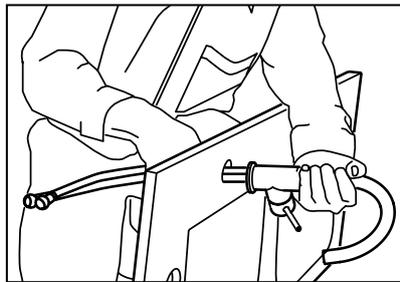
Nun befestigst du die Mischbatterie am Waschbecken, wie dies in der Montageanleitung der Mischbatterie beschrieben ist. Ziehe die Befestigungsmutter(n), die die Mischbatterie am Waschbecken fixieren, nur locker an. So kannst du die Mischbatterie korrekt am Becken positionieren. Ziehe dann die Mutter(n) fest.
