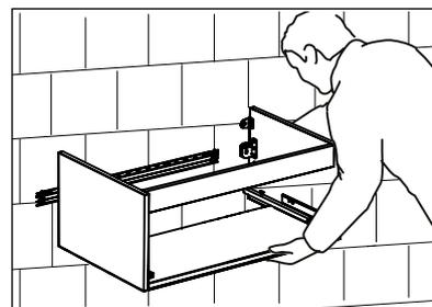
Stelle sicher, dass du die Fixiermöglichkeiten an der Rückseite des Waschbeckenschrankes gemäss Montageanleitung befestigt hast. Hänge dann den Schrank vorsichtig an die Befestigungsschrauben.
