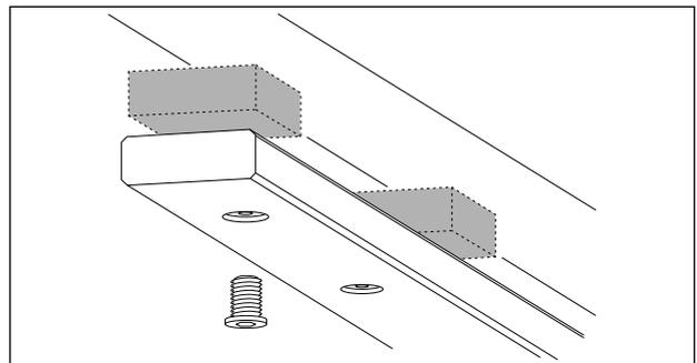
Detaillierte Ansicht, wie mit Distanzstücken die zu hohe Decke ausgeglichen wird.
