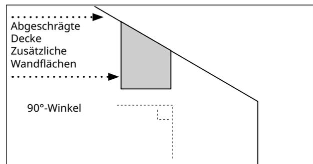
Detaillierte Ansicht der Vorbereitung für eine abgeschrägte Decke bei der Installation des SKYTТА Systems.
