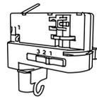
**SKENINGE Hängeleuchtenstecker.** Weiss. Der Anschluss der Leuchte an den Hängeleuchtenstecker muss durch einen Elektriker erfolgen. Das zulässige Höchstgewicht für eine oder mehrere Hängelampen an einer Schiene beträgt 5 kg. Du kannst z. B. 2 Hängeleuchten mit einem Gewicht von je 2,5 kg an einer Schiene aufhängen. Kann nur in Verbindung mit dem SKENINGE Schienensystem verwendet werden.
