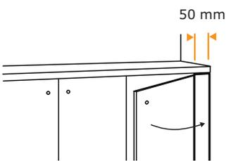
**07** Setze ein 50-mm-Füllstück zwischen Unter- und Wandschränken und der Wand, damit du Türen und Schubladen vollständig öffnen und schliessen kannst.
