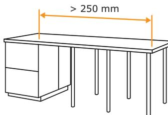
**08** Wenn die Arbeitsplatte mehr als 250 mm über den Unterschrank hinausragt, füge Stützen hinzu.
