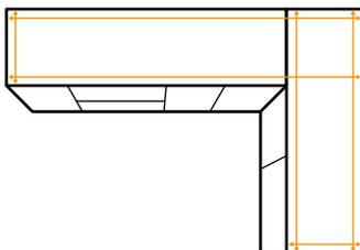
**02** Miss deine Arbeitsplatte von einer Ecke bis zum gegenüberliegenden Ende ab. Stelle sicher, dass du alle Längen- und Tiefenmasse von mindestens zwei Stellen aus abmisst. Denk daran, für Deckseite und Überhang 30 mm zur Länge hinzuzurechnen.
