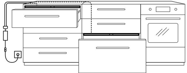
Für deine Schubladebeleuchtung kaufst du am besten einen separaten TRÅDFRI Treiber. Das erleichtert die Installation. Füge ein Verbindungskabel hinzu, wenn du mehr als einen Treiber benutzt. Kopple den Treiber für die Schubladebeleuchtung nicht mit deiner übrigen Küchenbeleuchtung, da dies die Funktionalität der Schubladebeleuchtung beeinträchtigen kann.
